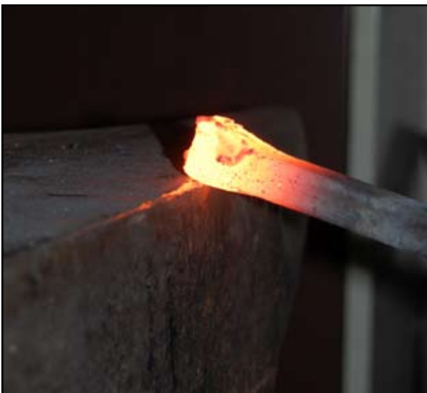
III: "Hodet" legges på kanten av ambolten.
