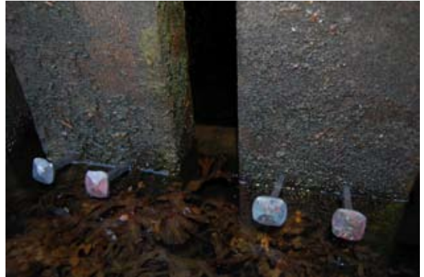
9: De fire spikerne er satt akkurat i flomålet, slik at de blir utsatt for vekselvis luft og vann.
