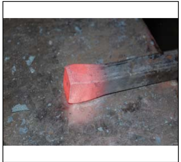
II: Det er stuket et "hode" på firkantstålet som skal formes til en sveiseleppe.
