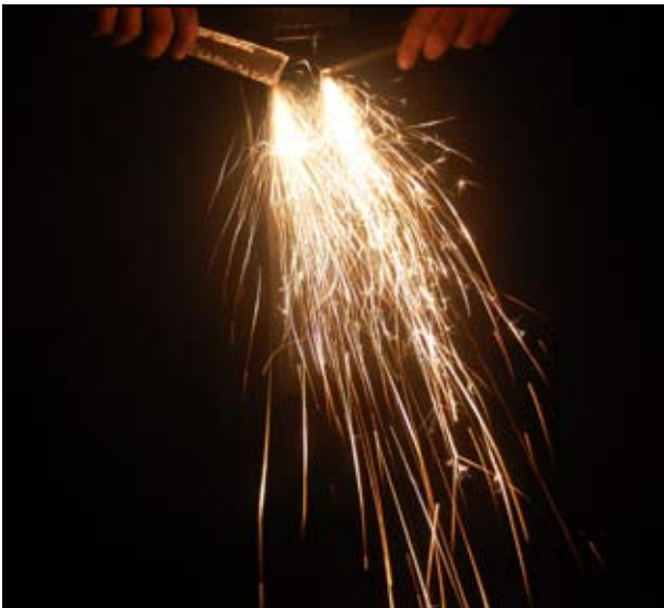
7: Prøven til høyre er karbonholdig. Den lager mer "stjerneskudd" enn prøven til venstre.
