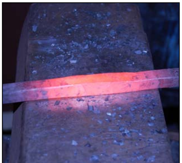
XII: Sveisen er ferdig. Firkantstålet har nå samme dimensjon (16 mm) hele veien.
