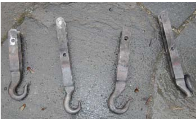
10: De fire beslagene som ble utsatt for belastningsprøven (etter prøven).
