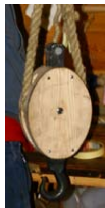
11: Til venstre en av testblokkene. Blokken har hundsvott , det vil si at beslaget er gjennomgående, med en bolt i enden.
